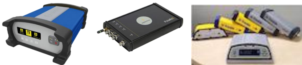
Ilustración 8 Receptores Stonex SC2200, Septentrio PolRx5. Fuente:(Septentrio, 2021; STONEX, 2022) , (Trimble Inc & Michael Bruno, 2018)
