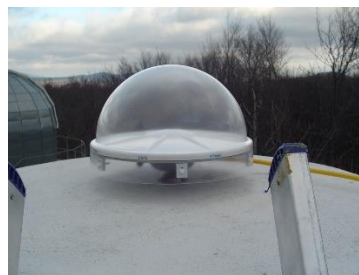
Ilustración 11 Ejemplo Radome para la estación MOP2. Fuente: EUREF.
