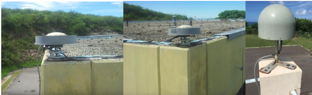
Ilustración 6 Ejemplo de Monumentación sobre edificación, estación CORD. Fuente: IGS, (Zaino, 2022)
