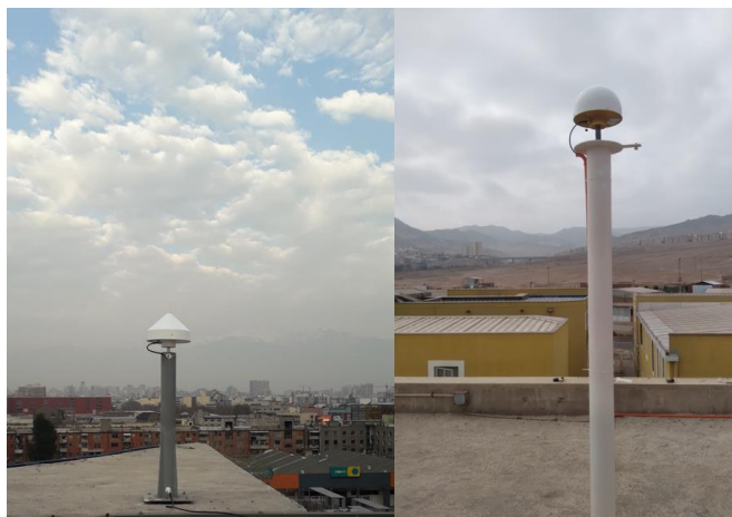
Ilustración 4 Ejemplos de entorno abierto en estaciones USCL (izquierda) y ANTF (derecha). Fuente: IGS.
