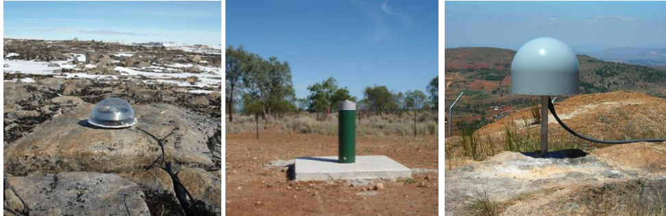
Ilustración 2 Ejemplos de Monumentación en superficie rocosa en estaciones CASI, MCHL y ABPO. Fuente: IGS.
