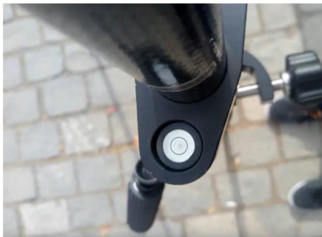
Ilustración 20 Verificación de verticalidad Fuente: Centro USC
